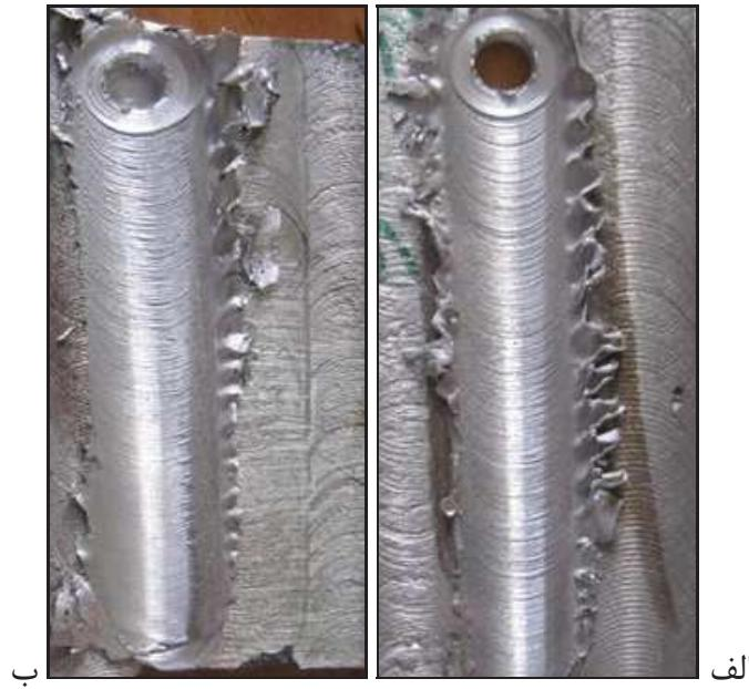
شکل ۲- الف و ب نمونه‌ای از قطعات جوشکاری شده
