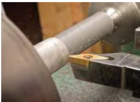
شکل ۱- نمایی از یک مکس فاز در حین ماشین‌کاری [۱۲].
