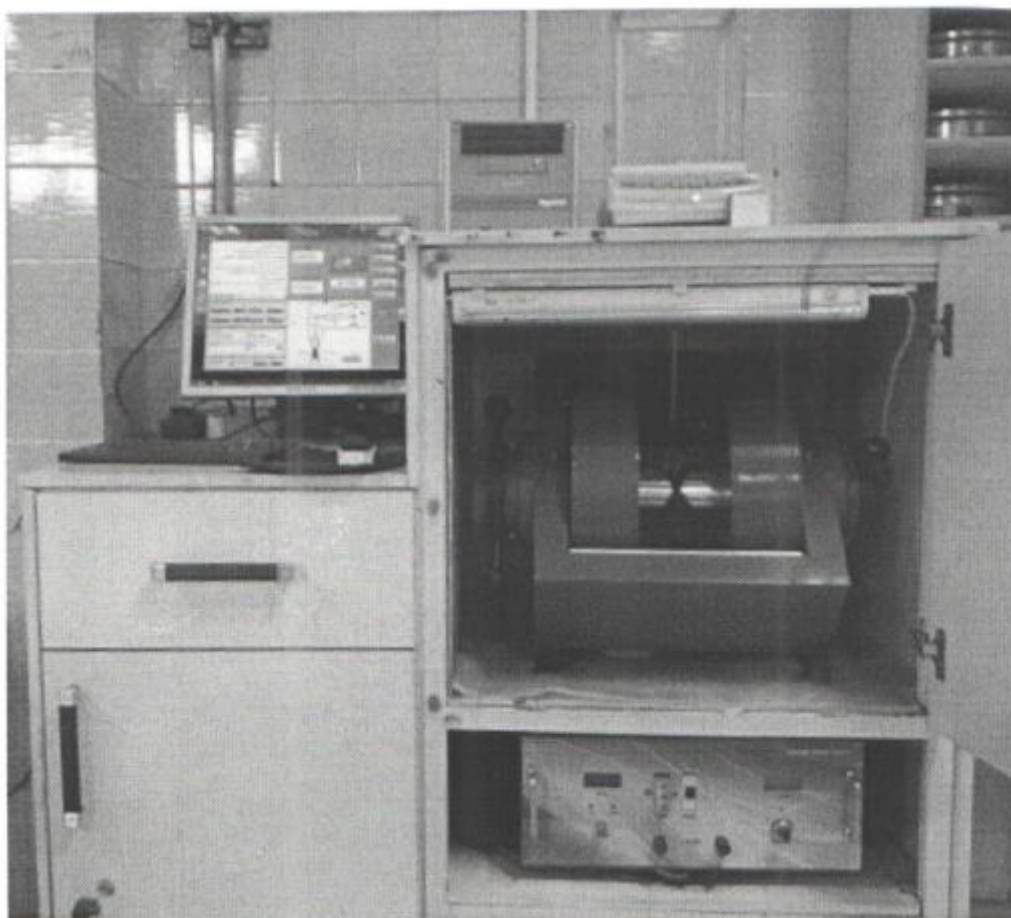
شکل ۳ دستگاه اندازه گیری FeO مورد استفاده در این تحقیق
