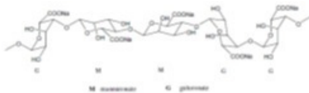
شکل ۱- ساختار سدیم آلزینات، فرمول شیمیایی بلوک GM، بلوک MM و بلوک GG [۹]
