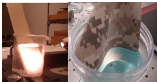
شکل ۸- (الف) سمت چپ: نور منعکس شده از لایه هوای محبوس بر روی یک چسب چوبی همراه با پوشش ابرآبگریز و (ب) سمت راست: نور منعکس شده از لایه هوای محبوس بر روی یک محصول ابرآبگریز
