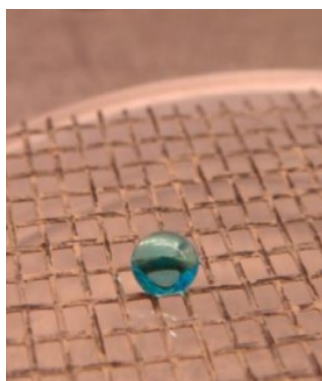
شکل ۹- قطره آب دفع شده توسط یک صفحه توری سیمی همراه با پوشش ابرآبگریز
