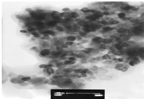
شکل (۴) تصویر TEM نانوکامپوزیت ۹۰CdO-۱۰CdO٪
