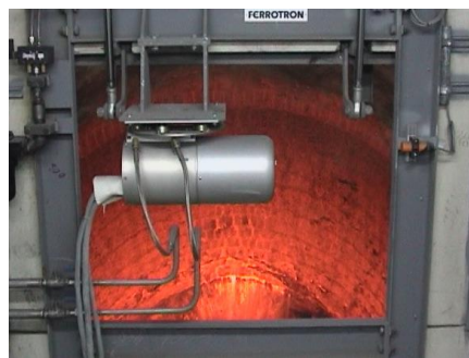
شکل ۵: نسل چهارم سیستم اندازه‌گیری لیزری LacamR [۶]
