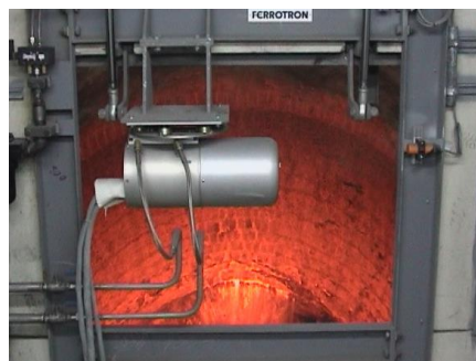
شکل ۵: نسل چهارم سیستم اندازه‌گیری لیزری LacamR [۶]
