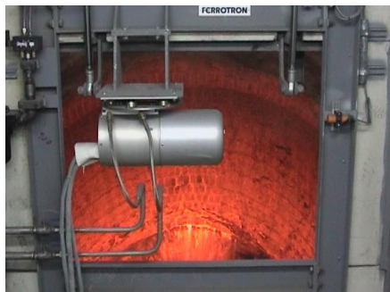
شکل ۵: نسل چهارم سیستم اندازه‌گیری لیزری LacamR [۶]
