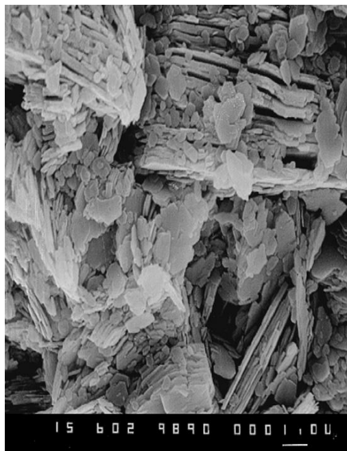
شکل ۲- تصویر SEM یک نوع کائولن [۱۷]
