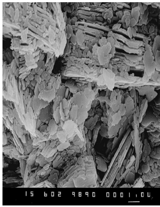
شکل ۲- تصویر SEM یک نوع کائولن [۱۷]
