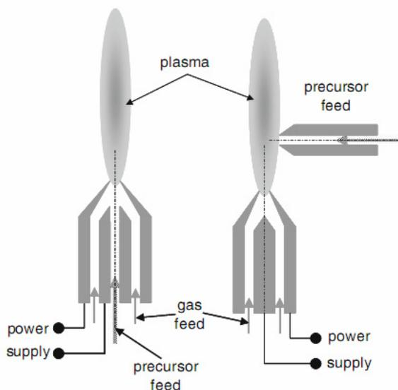
شکل ۸- طراحی مشعل‌های پلازما برای سنتز نانوپودر با استفاده از الکترودها. طراحی‌ها در منبع پیش‌ماده فرق می‌کنند. هر دو نوع طراحی اجازه استفاده از مایعات یا پودرها را به عنوان پیش‌ماده می‌دهند.
