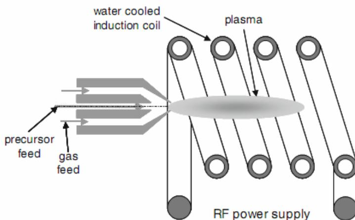
شکل ۹- طرح کلی دستگاه سنتز RF با پلاسمای جفت شده القائی.
