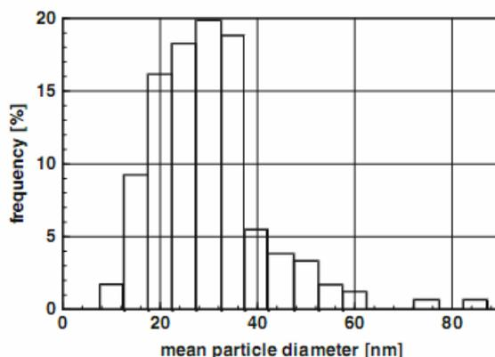
شکل ۲۳- ذرات  $\text{Fe}_2\text{O}_3$  تولید شده با فرآیند کندگی لیزری. لطفاً به توزیع نسبی اندازه ذرات توجه کنید که نمونه‌ای برای فرآیندهای کندگی لیزری تحت فشار محفظه است [۵۱].
