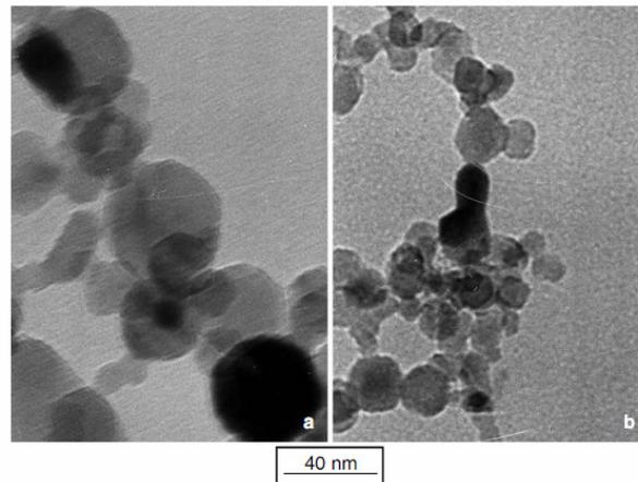
شکل ۲۶- ذرات  $\text{TiO}_2 \text{ ex TiCl}_4$  در شعله متان - اکسیژن پیش‌آمیخته. (a) مواد تولید شده بدون میدان الکتریکی. (b) محصول به‌دست آمده از میدان الکتریکی عرضی  $1/6 \text{ kVcm}^{-1}$ . کاهش اندازه ذرات به خوبی قابل مشاهده است. به علاوه، توزیع اندازه این ذرات بسیار باریکتر است.
