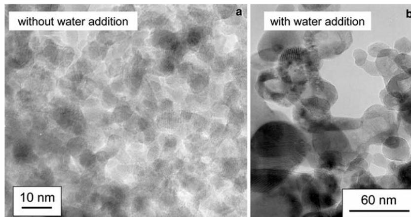
شکل ۲- توزیع اندازه ذرات زیرکونیای سنتز شده در پلاسما میکروویو [۱۳]. (a) پودر در شرایطی به‌دست آمده که پدیده دفع بار فعال می‌شود. ذرات کوچک هستند و توزیع اندازه ذرات باریکی دارند. (b) پودر در شرایطی به‌دست آمده که بار الکتریکی ذرات با اضافه شدن آب خنثی می‌گردد. به دلیل آنکه ذرات باردار نیستند، توزیع اندازه ذرات بسیار گسترده است.
