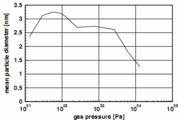
شکل ۲۲- قطر متوسط ذرات  $\text{Co}_3\text{O}_4$  تولید شده از یک هدف با ترکیب مشابه در اتمسفر گازی به وسیله فرآیند کندگی لیزری. کوچکترین اندازه ذرات در کمترین و بیشترین فشارهای گازی مشاهده شده است. یک لیزر اکسایمر ArF به عنوان منبع انرژی به کار می‌رود [۵۰].
