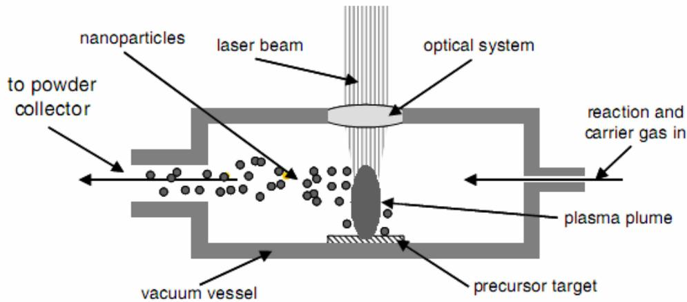
شکل ۲۱- طرح کلی یک دستگاه تجربی برای سنتز پودر با استفاده از کندگی لیزری. اشعه لیزر پالسی در سطح پیش‌ماده، هدف، فلز یا اکسید متمرکز می‌گردد و آن را بخار می‌کند. پلوم، یک جریان شدید بسیار یونی از ماده بخار شده است که به صورت عمودی از سطح هدف خارج می‌گردد.
