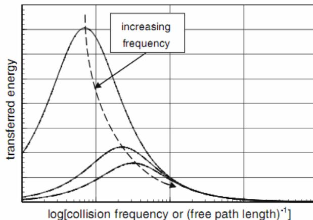
شکل ۱- انرژی منتقل شده در پلاسما به ذرات باردار با تابعی از فرکانس برخورد در گاز. با افزایش فرکانس میدان الکتریکی، ماکزیمم انتقال به فرکانس‌های بالاتر برخورد حرکت می‌کند.
