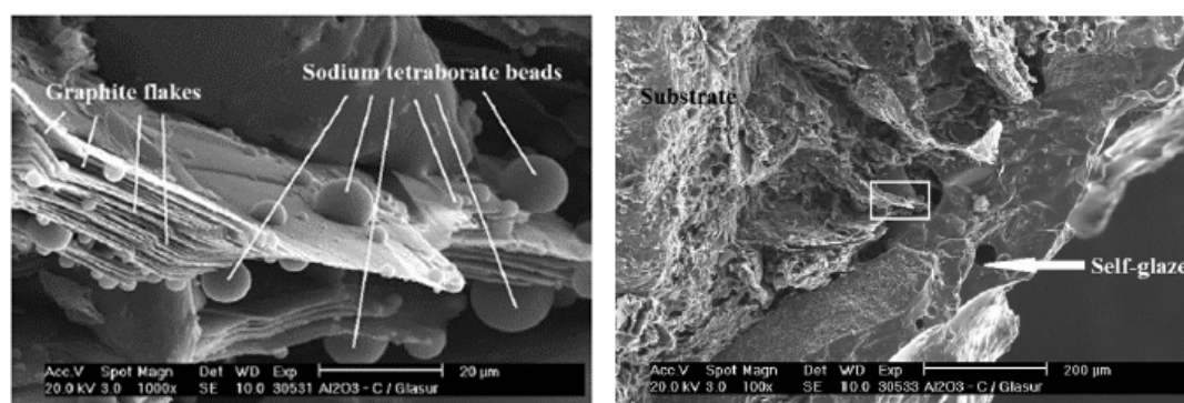
شکل ۶- تصویر میکروسکوپ الکترونی از چپ: سطح لعب و راست: فصل مشترک زیرلایه و لعب بعد از اکسیداسیون [۳]
