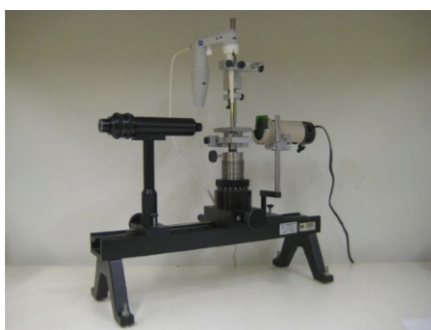
شکل ۱۷- تلسکوپ زاویه سنج - گونیومتر [۳۴].
