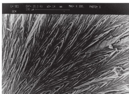
شکل ۷- ریزساختار نمونه GC.۴ پس از عملیات حرارتی (بزرگنمایی ۳۰۰)
