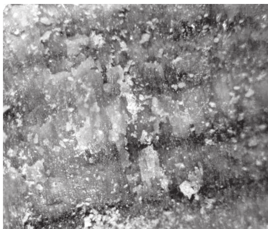
شکل ۳- تصویر میکروسکوپ نوری بازتابی از ساختار لایه‌ای سنگ مرمر (بزرگنمایی ۶۴ برابر)
