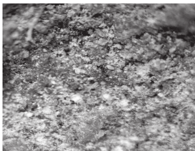
شکل ۴- تصویر میکروسکوپ نوری بازتابی از بافت دانه شکری سنگ مرمر (بزرگنمایی ۶۴ برابر)
