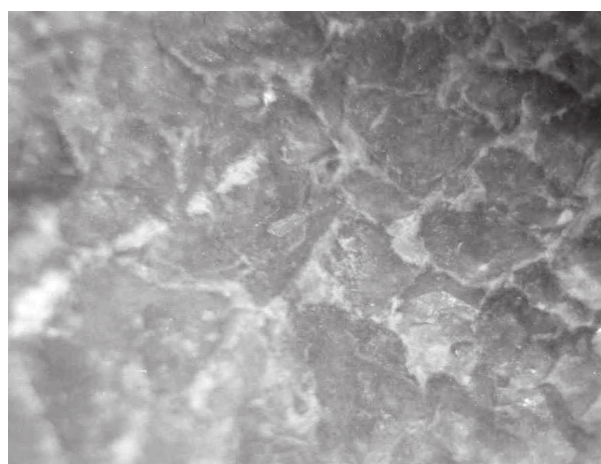
شکل ۵- تصویر میکروسکوپ نوری بازتابی از پدیده انحلال و تجمع بلورهای ریز و سفید رنگ پیرامون بلورهای اولیه کلسیت (بزرگنمایی ۶۴ برابر)
