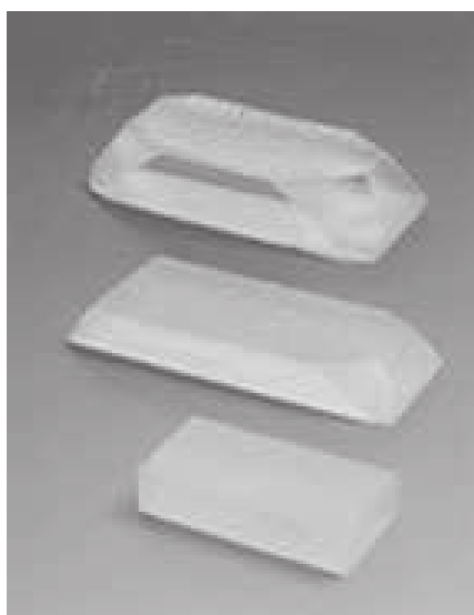
شکل ۱- بلورهای هیدروکوارتز سنتز شده به روش هیدروترمال
