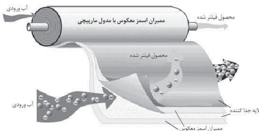
شکل ۶- نمای شماتیک ممبران مارپیچی [۵]
