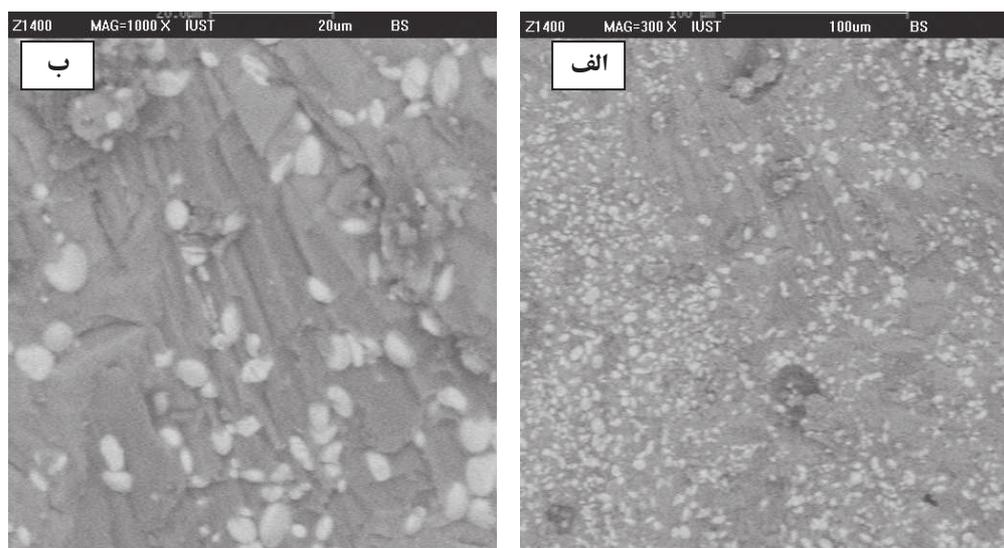
شکل ۴- تصویر میکروسکوپ الکترونی الکترون بازگشتی، از نمونه کلسینه شده در دمای  $1400^{\circ}\text{C}$
