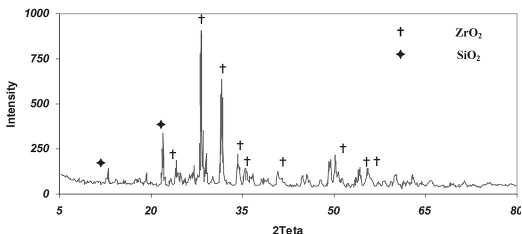
شکل ۵- آنالیز فازی از نمونه ژل کلسینه شده در  $1100^{\circ}\text{C}$  حاصل از نمونه کلسینه شده در  $1400^{\circ}\text{C}$  و شسته شده در  $\text{HCl}$  در روش ذوب آهکی
