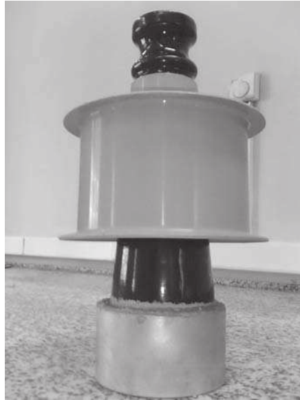
شکل ۵- نمونه مقره سرامیکی - پلیمری ساخته شده
