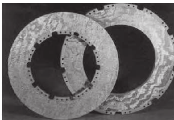
شکل ۴- دیسک‌های ترمز هواپیمای غیر نظامی از جنس کامپوزیت C/C [۴]
