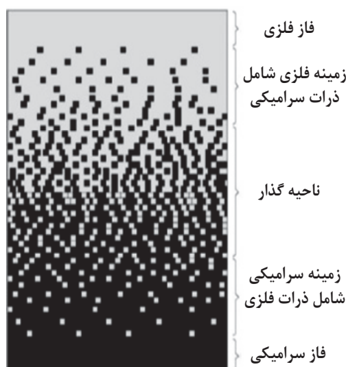
شکل ۱- طرحواره‌ای از ساختار یک نمونه FGM [۲]
