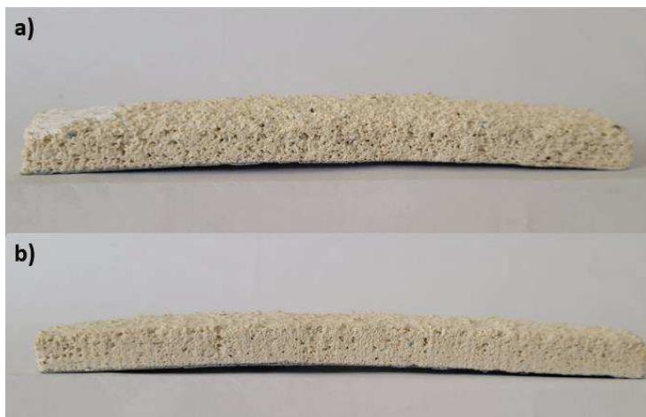
شکل ۵. مقاومت به شکم‌دهی نمونه‌های پخت‌شده در دمای ۱۴۰۰ درجه سانتی‌گراد: (a) نمونه تهیه‌شده با دوغاب A، (b) نمونه تهیه‌شده با دوغاب B.
