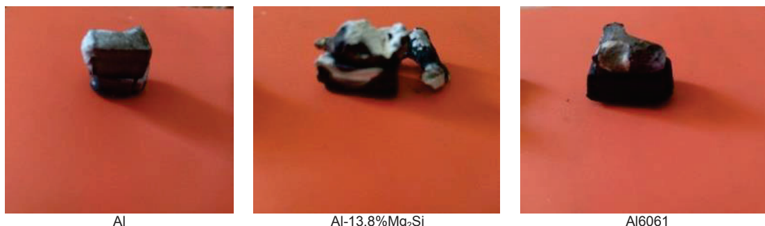
شکل ۱: تصاویر نمونه‌های تزریق نشده در کوره تحت خلا در دمای ۱۰۰۰ درجه سانتی‌گراد و با نرخ گرمایش ۱۰ درجه سانتی‌گراد بر دقیقه با زمان ماندگاری ۱ ساعت
