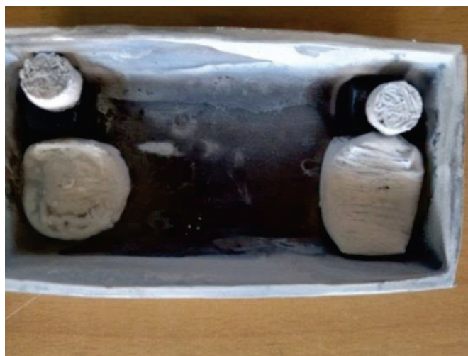
شکل ۳: تصویر پیش ساخته تزریق نشده با فلز در داخل کوره تحت گاز آرگون در دمای ۱۳۰۰ درجه سانتی گراد با نرخ گرمایش ۵۰ درجه سانتی گراد بر دقیقه به مدت ۱۰ دقیقه
