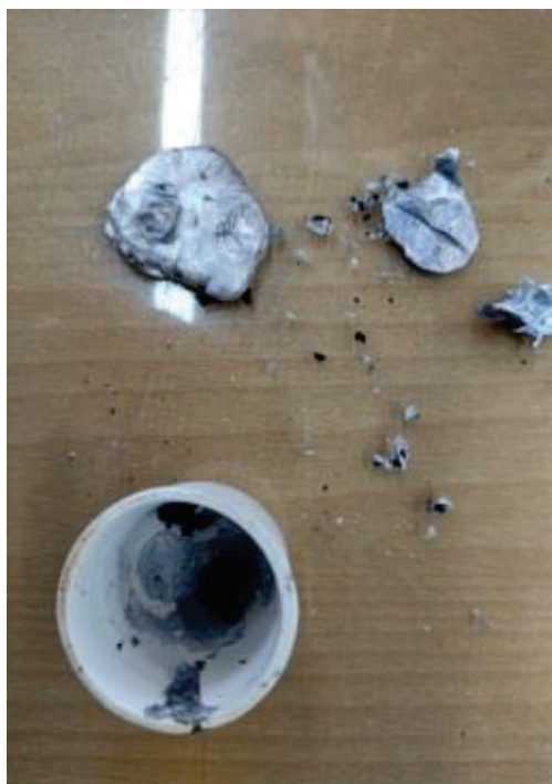
شکل ۲: تصویر بدنه متخلخل تزریق نشده به همراه مذاب تخلیه شده پس از خروج از کوره تحت اتمسفر اکسیدی در دمای ۱۳۰۰ درجه سانتی گراد با زمان ماندگاری ۱۰ دقیقه
