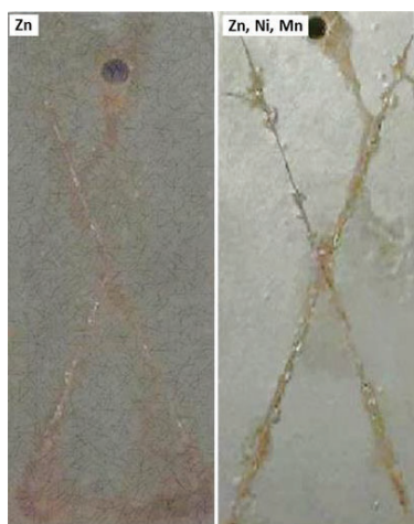
شکل ۱۰: تصاویر سطح نمونه‌های فسفات‌ده و رنگ‌شده پس از ۲۴۰ ساعت آزمایش پاشش نمک
