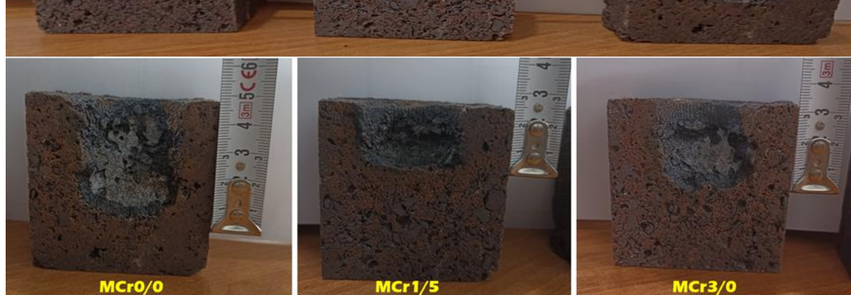
شکل ۸: تصاویر مربوط به سطح مقطع و میزان عمق خوردگی نمونه‌های فاقد و شامل ۱/۵ و ۳ درصد افزودنی کرومیا پس از آزمون مقاومت به خوردگی
