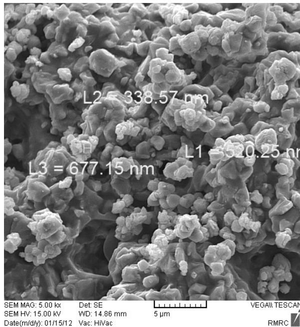
شکل ۴- تصویر SEM نمونه حاوی MgO , Al , TiO_2 و C پخته شده در دمای 1600^\circ C به مدت ۳h در بستر کک
