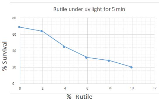
شکل ۴- اثر مقدار روتایل بر درصد سلول‌های زنده تحت فرابنفش به مدت ۵ دقیقه و در غلظت اولیه ( $\text{CFU}/\text{ML}$ )  $۳/۷ \times 10^4$
