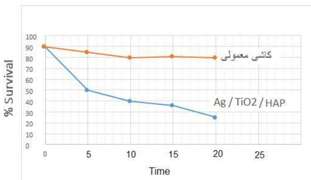
شکل ۷- مقایسه اثر ضد باکتریایی کاشی معمولی و کاشی حاوی نقره/ دی اکسید تیتانیوم/ هیدروکسی آپاتیت در معرض نور مرئی
