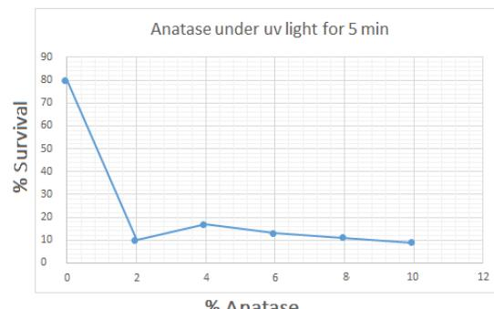
شکل ۳- اثر مقدار آناتاز بر درصد سلول‌های زنده تحت فرابنفش به مدت ۵ دقیقه و در غلظت اولیه ( $\text{CFU}/\text{ML}$ )  $۲/۷ \times 10^4$
