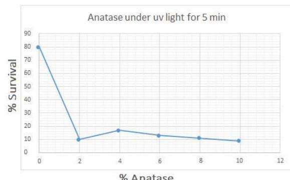
شکل ۶- بررسی اثر ضد باکتریایی کاشی حاوی آناتاز / هیدروکسی آپاتیت و روتایل / هیدروکسی آپاتیت در معرض نور فرابنفش به مدت ۵ دقیقه
