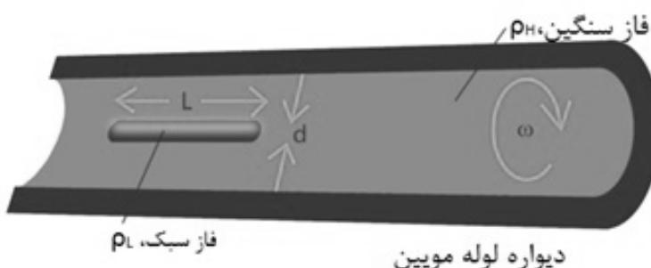
شکل ۴- شماتیک دو مایع درون یک لوله بسته برای اندازه‌گیری به روش کشش سطحی<sup>۳</sup>
