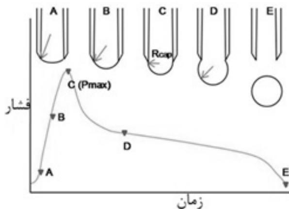
شکل ۵- نمودار فشار-زمان حبابی که در سر لوله موین تشکیل می‌شود.<sup>۲</sup>
