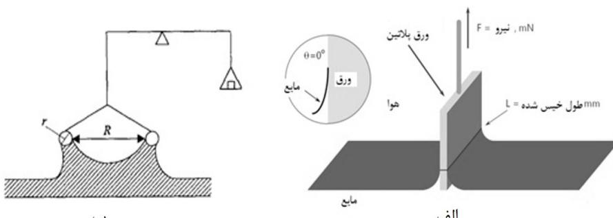
شکل ۲- (الف) شماتیکی از روش ویلهلمی<sup>۵</sup> ب) شماتیک روش حلقه
