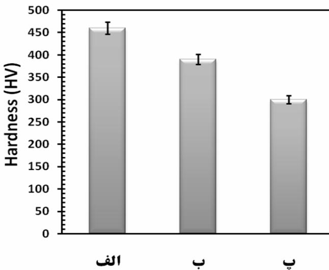
شکل ۵- متوسط نتایج آزمایش سختی با حداقل ۳ بار تکرارپذیری در نمونه‌های ریخته‌گری شده در قالب:
