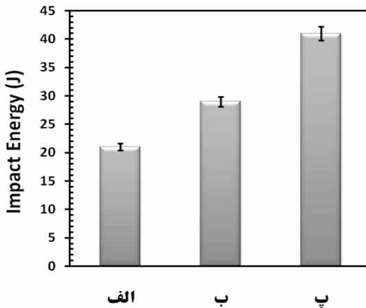
شکل ۶- متوسط نتایج آزمایش ضربه شاربی با حداقل ۳ بار تکرار پذیری در نمونه‌های ریخته‌گری شده در قالب:
