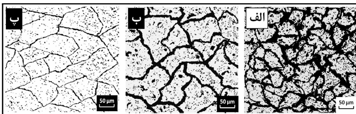
شکل ۳- تصاویر متالوگرافی فولاد مورد استفاده در این پژوهش در بزرگنمایی ۱۰۰ تولید شده در قالب:
