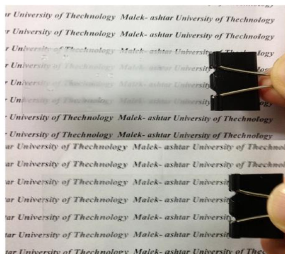
شکل ۱۳- تصویر شیشه بدون پوشش (بالایی) و شیشه با پوشش ضدمه (پایینی) [۲۳].
