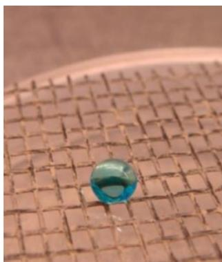
شکل ۹- قطره آب دفع شده توسط یک صفحه توری سیمی همراه با پوشش ابرآگریز
