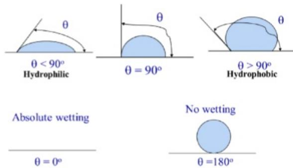
شکل ۲- شرایط ترشوندگی آبدوستی و آبگریزی: زاویه ترشوندگی صفر معادل ترشوندگی کامل، زاویه ترشوندگی کمتر از  $90^\circ$  درجه معادل آبدوست، زاویه ترشوندگی بیشتر از  $90^\circ$  درجه معادل آبگریز و زاویه ترشوندگی  $180^\circ$  درجه معادل عدم ترشوندگی.
