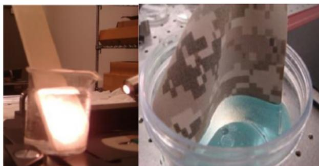
شکل ۸- (الف) سمت چپ: نور منعکس شده از لایه هوای محبوس بر روی یک چسب چوبی همراه با پوشش ابرآگریز و (ب) سمت راست: نور منعکس شده از لایه هوای محبوس بر روی یک محصول ابرآگریز
