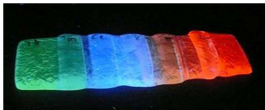
شکل ۳- همجوشی شیشه سیلیکات سودا-لایم با اکسیدهای خاکی کمیاب. از چپ به راست: تربیم، تولیوم، سریوم، دیسپروسیوم، ساماریوم و یوروپیوم [۹].
