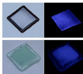
شکل ۵ - رنگ‌دانه فسفرسانس بنفش - آبی به کاربرده شده بر روی سطوح شیشه‌ای تخت و حضور آن‌ها در نور روز (چپ) و در تاریکی (سمت راست) [۱۸].
