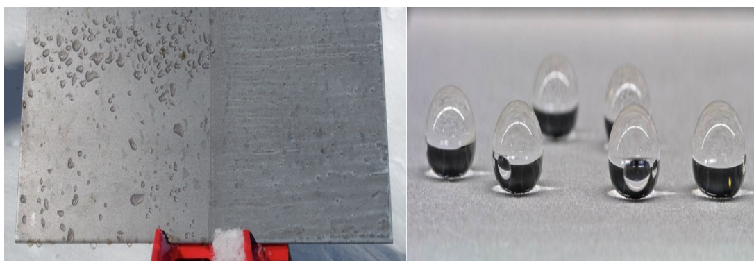
شکل ۴- سطوح آلومینیوم پوشش‌ده شده و بدون پوشش به‌وسیله پوشش‌های فوق‌آبگریز [۶].
