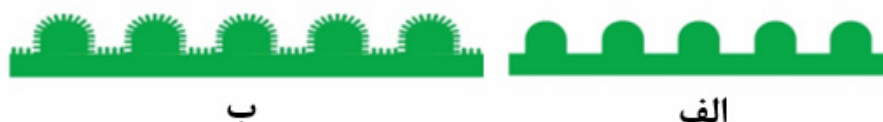
شکل ۱۶- (الف) یک سطح ساده با بافت میکرو (ب) یک سطح با بافت سلسله مراتبی میکرو-نانو [۲۴]
