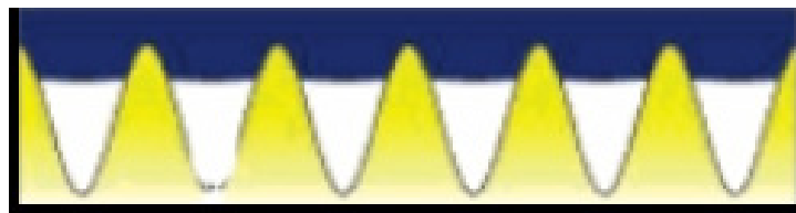
شکل ۸- تصویر شماتیکی از یک قطره در حالت کیسی-باکستر که در آن پستی بلندی‌های سطح گرد هستند [۲۳].
