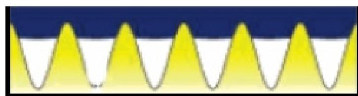
شکل ۸- تصویر شماتیکی از یک قطره در حالت کیسی-باکستر که در آن پستی بلندی‌های سطح گرد هستند [۲۴].
