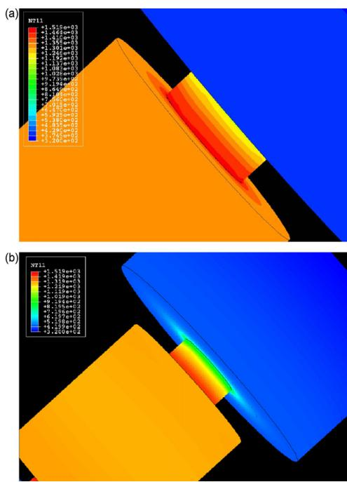
شکل ۱۵- شبیه‌سازی توزیع دما در سطح قالب و پانچ‌ها پس از گذشت ۴۵۰ ثانیه از فرآیند SPS: (a) سطح قالب گرافیتی و (b) محل اتصال پانچ/صفحه گرافیتی [12]
