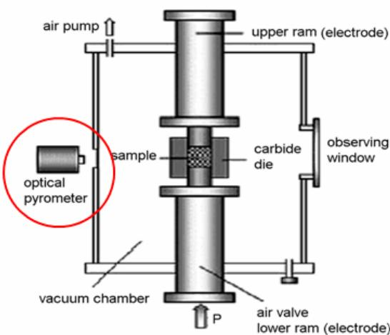
شکل ۱۳- استفاده از پیرومتر برای اندازه‌گیری دما در روش [10] SPS
