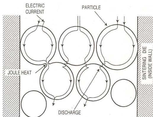
شکل ۴- تصویر شماتیک عبور پالس‌های جریان از میان ذرات پودر و تولید حرارت (تشکیل ناحیه گلوبی) [5, 7]
