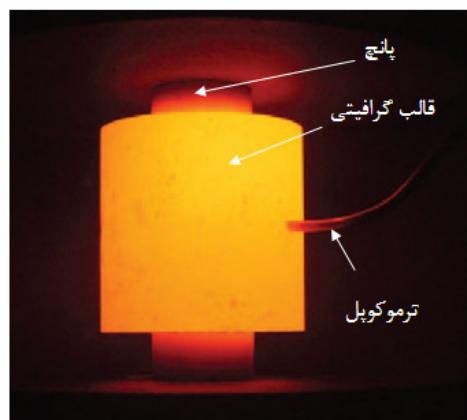
شکل ۱۲- استفاده از ترموموکوپل برای اندازه گیری دما در روش SPS [10]
