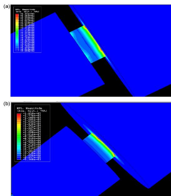
شکل ۱۸- شبیه‌سازی توزیع حرارت روی سطح قالب و پانچ در فرآیند SPS پس از گذشت: (a) ۹۰ ثانیه و (b) ۴۵۰ ثانیه [13].
