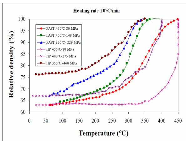
شکل ۲۰- مقایسه دانسیته نسبی به دست آمده در روش‌های HP و SPS برای پودر [15] Al-Si-Fe
