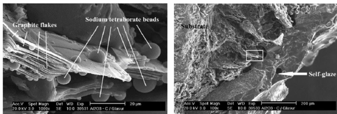
شکل ۶- تصویر میکروسکوپ الکترونی از چپ: سطح لعاد و راست: فصل مشترک زیرلایه و لعاد بعد از اکسیداسیون<sup>[۲]</sup>
