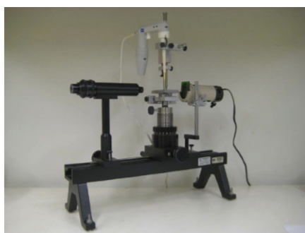
شکل ۱۷- تلسکوپ زاویه سنج - گونیومتر [۳۴].
