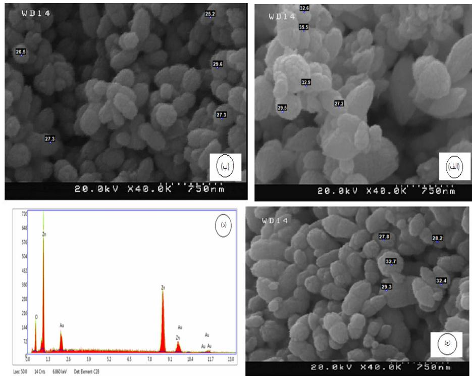
شکل ۲- (الف، ب، ج) به ترتیب تصاویر SEM نانو ذرات Zn09 Zn10 Zn11 و Zn10 نمونه Zn10 طیف EDX می‌باشد.
