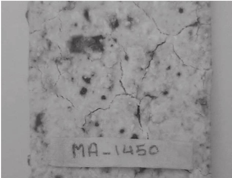
شکل ۶- بتون دیرگذار کم سیمان پایه آندالوزیت ملایر پخته شده در دمای  $1450^{\circ}\text{C}$ ، در این تصویر ترک های موجود در نمونه به وضوح قابل مشاهده می باشند
