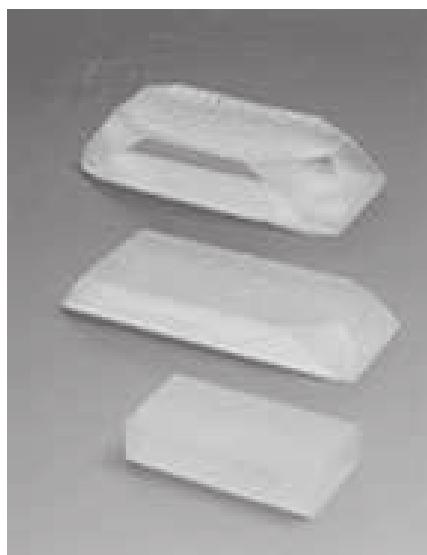
شکل ۱ - بلورهای هیدروکوارتز سنتز شده به روش هیدروترمال
