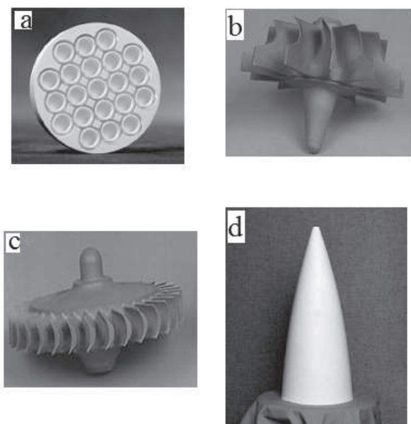
شکل ۲- نمونه‌هایی از قطعات شکل داده شده به روش ریخته‌گری ژلی، (a) روتور توربین از جنس نیترید سیلیکون به قطر ۱۵ cm، (b) بوته‌های خام آلومینایی ماشین کاری شده (قطر هر کدام ۶ cm)، (c) روتور توربین از جنس نیترید سیلیکون به قطر ۱۸ cm، (d) مخروط آلومینایی به طول ۶۰ cm و قطر قاعده ۲۰ cm [۲۰].
