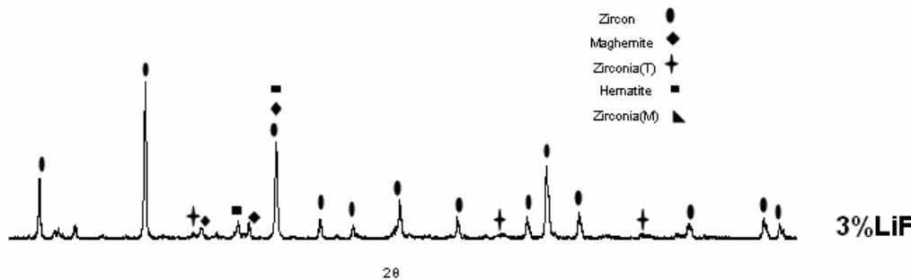
شکل ۴- پراش اشعه X از نمونه حاوی کانی ساز 3%LiF
