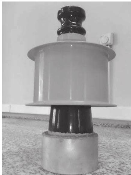
شکل ۵- نمونه مقره سرامیکی- پلیمری ساخته شده
