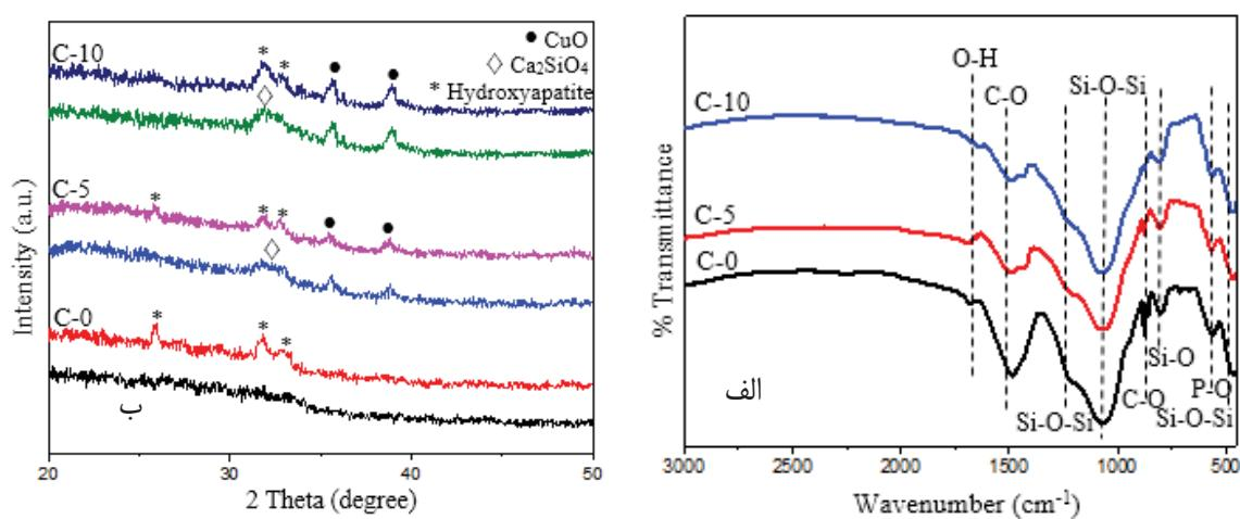
شکل ۱ (الف) طیف FTIR و (ب) الگوی XRD نمونه‌های C-0، C-5 و C-10 بعد از ۷ روز غوطهوری در SBF
