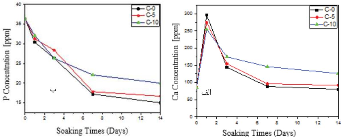
شکل ۲- تغییرات غلظت (الف) کلسیم و (ب) فسفر نمونه‌های C-0، C-5 و C-10 بعد از ۱، ۳، ۷ و ۱۴ روز غوطه‌وری در SBF
