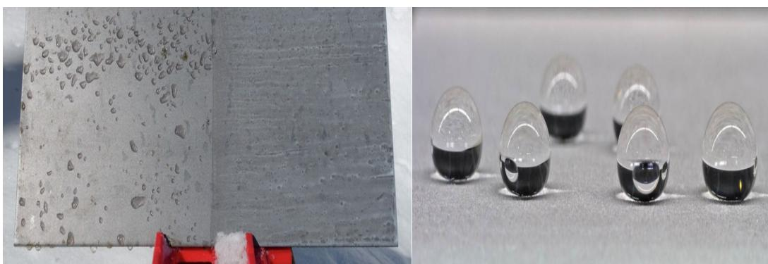
شکل ۴- سطوح آلومینیوم پوشش‌داده شده و بدون پوشش بهوسیله پوشش‌های فوق‌آبگریز [۶].
