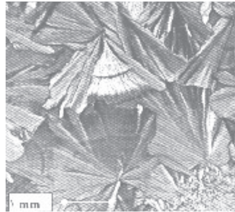
شکل ۹- تصویر میکروسکوپ نوری بلورهای لعاب پایه (نیلوفر) و افزودنی ۵ در صد وزنی کربنات منیزیم.
