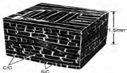
شکل ۶- نمای سه بعدی کامپوزیت C/C-SiC [۴]
