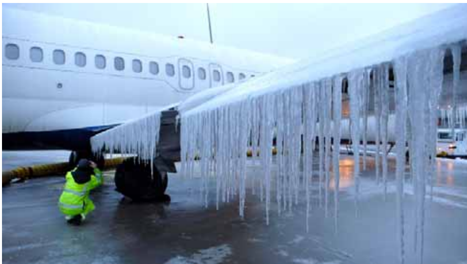
شکل ۱۹- رشد شدید یخ بر روی بال‌های هواپیما [۲۲].
