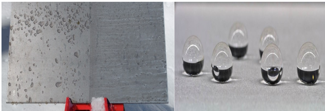
شکل ۴- سطوح آلومینیوم پوشش‌داده‌شده و بدون پوشش به وسیله پوشش‌های فوق‌آبگریز [۶].
