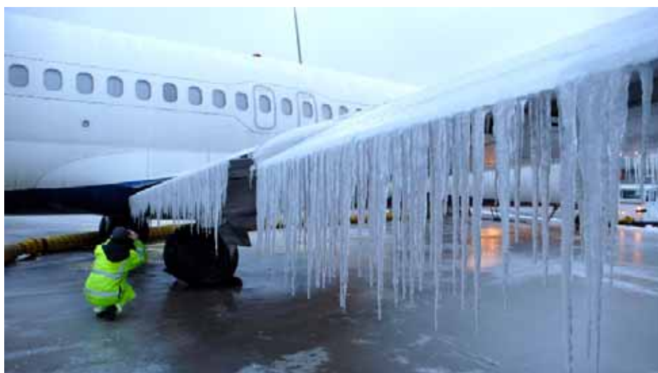
شکل ۱۹- رشد شدید یخ بر روی بال‌های هواپیما [۲۲].
