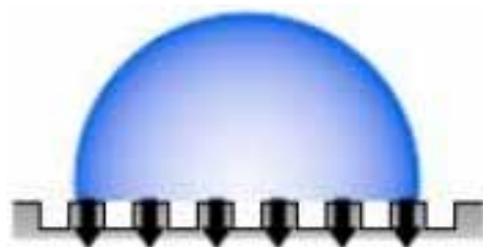
شکل ۱- یک قطره آب در حالت کسی-باکستر. پیکان‌ها انتقال حرارت از طریق فصل مشترک جامد-مایع را نشان می‌دهند[۵]
