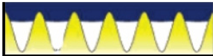
شکل ۸- تصویر شماتیکی از یک قطره در حالت کیسی-باکستر که در آن پستی بلندی‌های سطح گرد هستند [۲۳].
